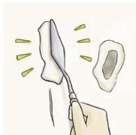
補修部の付着物や油分を取り除いた後、ペインティングナイフやヘラを使って、タッチアップ材を塗布します。
